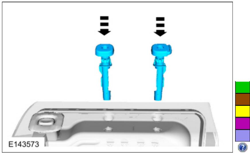
2. 用手向上拉头枕导套，确保其正确锁入靠背框架上的孔中。如果头枕的任一导套可以用手卸下，重复安装程序。如果头枕导套在第二次安装后还能被卸下，安装新的头枕导套。
